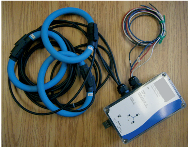
Figure 37 : Compteur de kilowatt à six canaux de lecture
