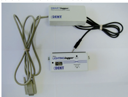
Figure 19 : Capteur de temps de fonctionnement des luminaires
