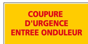
Figure 26: modèle d'étiquette pour l'identification des équipements
